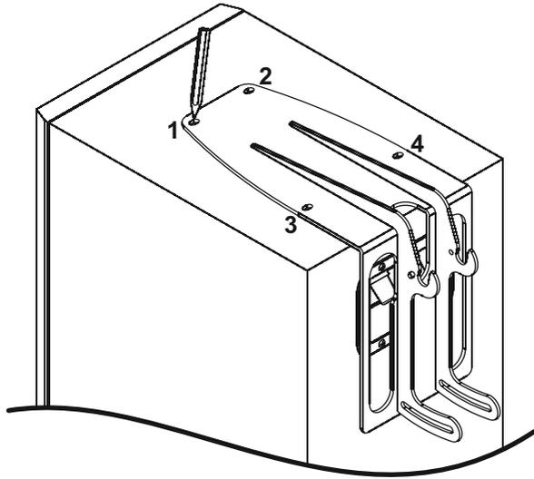
**b** Bohren Sie jetzt die vier Schraubenlöcher mit dem beigelegten Bohrer vor. Die Bohrlöcher sollten maximal 15 mm tief sein.
