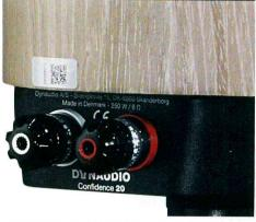
**FESTE VERBINDUNG**: Die Single-Wiring-Anschlüsse sind äusserst solide ausgeführt. In unserem Hörtest verkabelten wir die Confidence 20 via Gauder Clearwater mit einer AVM-Kette aus Evolution A 5.2 und Evolution MP 5.2.
